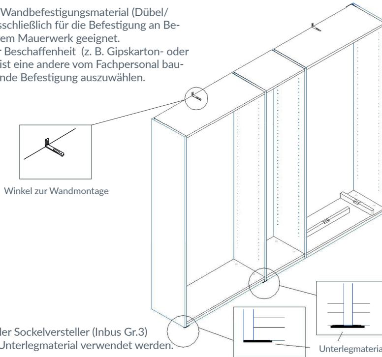
Nach Justierung der Sockelversteller (Inbus Gr.3) muss geeignetes Unterlegmaterial verwendet werden.
