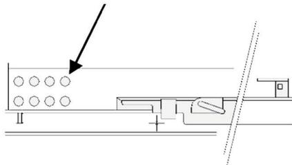
Die Schienen sind zusätzlich mit den beigelegten 3,5x16 Spax-Schrauben zu sichern (4x), Maximale Belastung: 40kg pro Schienenpaar (inkl. Schubkasten)
