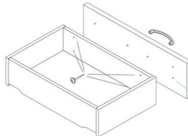
Griff mit Senkkopfschrauben M4 auf Schubkastenblende montieren; Schubkastenblende mit den mitgelieferten Spax-Schrauben am Schubkasten anschrauben
