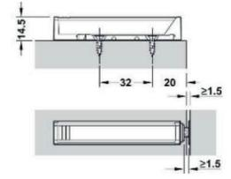
Bei Verwendung von Tip-On, ist der Dämpfer vom Topfscharnier zu deaktivieren (siehe oben). Tip-On optional zum Schrauben mittels Adapter oder zum Einbohren in die Vorderkante. Positionierung bauseits.
