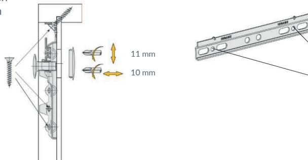
Das mitgelieferte Wandbefestigungsmaterial (Dübel/Schrauben) ist ausschließlich für die Befestigung an Beton und/oder festem Mauerwerk geeignet. Bei abweichender Beschaffenheit (z. B. Gipskarton- oder Leichtbauwände) ist eine andere vom Fachpersonal bauseits vorzunehmende Befestigung auszuwählen.
